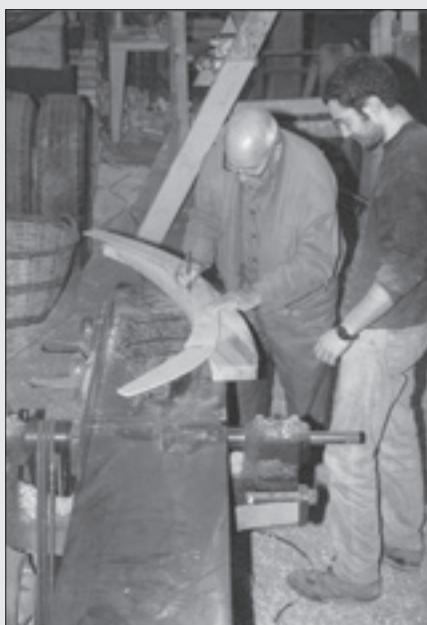
Ramon Gay, i un seu ajudant, en la primera fase de construcció d'una embarcació: preparant les peces amb les plantilles o patrons.
