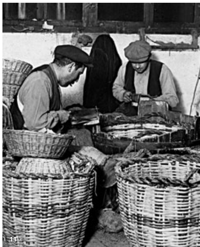
10. Extracció del bloc de suro aglomerat després de la seva cocció, 1925. AMSFG. Fons Ricard Mur Dargallo. (Autor: Ricard Mur Dargallo) 11. Elaboració de carracs a mà, 1925. AMSFG. Fons Ricard Mur Dargallo. (Autor: Ricard Mur Dargallo) 12. Fabricació de taps amb màquina de barrina, 1925. AMSFG. Fons Ricard Mur Dargallo. (Autor: Ricard Mur Dargallo)
