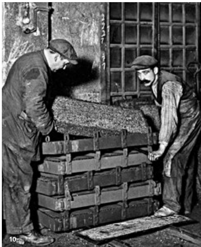
10. Extracció del bloc de suro aglomerat després de la seva cocció, 1925. AMSFG. Fons Ricard Mur Dargallo. (Autor: Ricard Mur Dargallo) 11. Elaboració de carracs a mà, 1925. AMSFG. Fons Ricard Mur Dargallo. (Autor: Ricard Mur Dargallo) 12. Fabricació de taps amb màquina de barrina, 1925. AMSFG. Fons Ricard Mur Dargallo. (Autor: Ricard Mur Dargallo)
